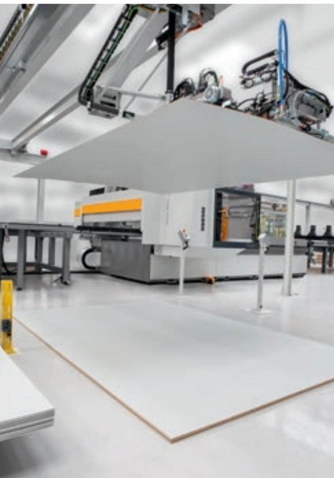
El almacén automático Winstore prepara las pilas de las placas de varios formatos y tipos, incluso mixtas, sin necesidad de operarios. La reorganización del almacén de las placas y la preparación de las pilas se lleva a cabo de forma automática, incluso fuera del horario laboral.
